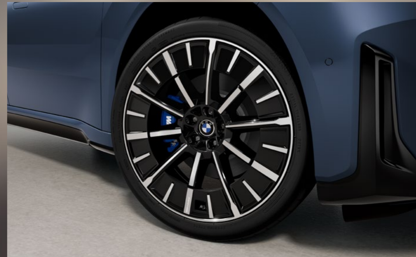
3NV 22" BMW Individual Aerodynamikrädern 1053 I Bicolor Alu-Gussrad, Jetblack Uni, glanzgedreht
